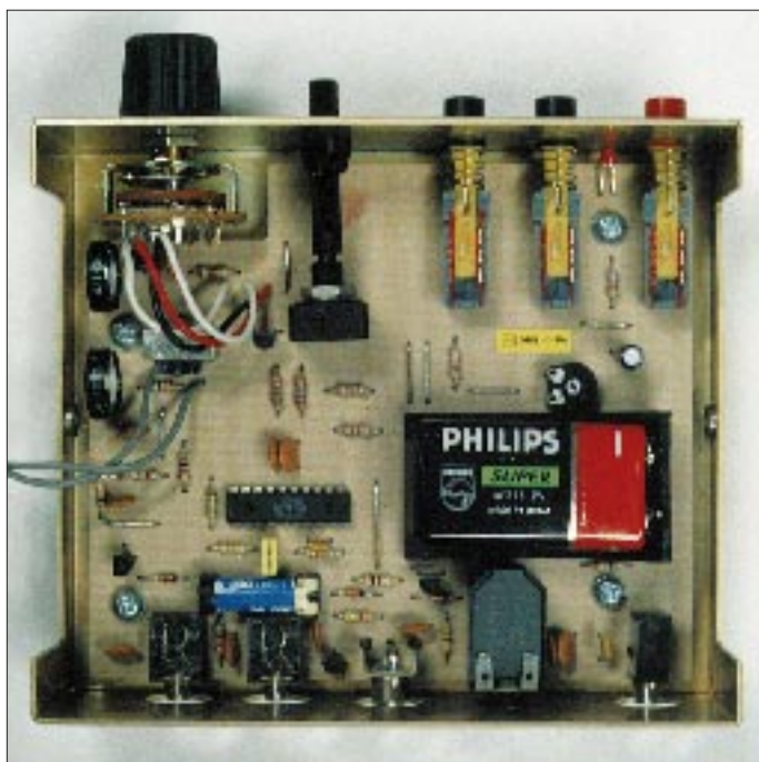
Bild 3: Das Gerät im aufgeklappten Zustand. Direkt unterhalb der Batteriehalterung der Steller für die Wichtung. Das Potentiometer für die Gebe-geschwindigkeit ist mit der 6-mm-Achse (!) auf der Platine be-festigt. Der 8044 ABM sitzt rechts von der Batteriehalterung. Der Lautsprecher für Mithören ist auf der U-förmigen Abdeckhaube befestigt.
