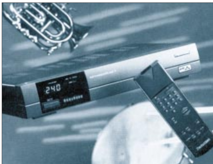
ADR-Receiver AX 1 der Firma Technisat. Das Gerät zeigt als Zusatzdaten noch Titel, Interpret, Komponist, Album, CD-Nr. usw. an. Diese Daten können auch auf eine (optionale) bidirektionale Fernbedienung übertragen und dort abgelesen werden. Der Receiver läßt sich auch über eine serielle Computerschnittstelle steuern und vorprogrammieren. Werkfoto
