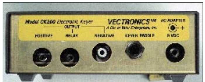
Bild 2: Rückansicht des CK 200. V.l.n.r. die Buchsen für die getrennten Tastausgänge (negativ: Cinch; Relais: 3,5-mm-Klinke; Stereo; positiv: 3,5-mm-Klinke, Stereo), die Gebemechanik (Klinke 6,3 mm, Stereo) sowie die 9-V-Spannungsversorgung (Klinke 3,5 mm, Mono)
