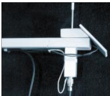
Bild 6: Alle Bestandteile der fertigen Aktivantenne werden mechanisch stabil an einem Holzgestell befestigt.
