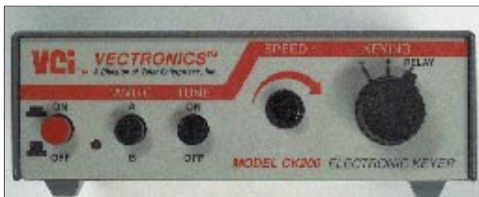
Bild 1: Frontansicht des CK 200 von Vecronics. An der Frontplatte befinden sich v.l.n.r.: Einschalter, Umschalter Iambic A/B, Abstimm- schalter (Dauerträger), Steller Gebegeschwindigkeit sowie Umschal- ter für die Tastausgänge (positiv, negativ, Relais)
